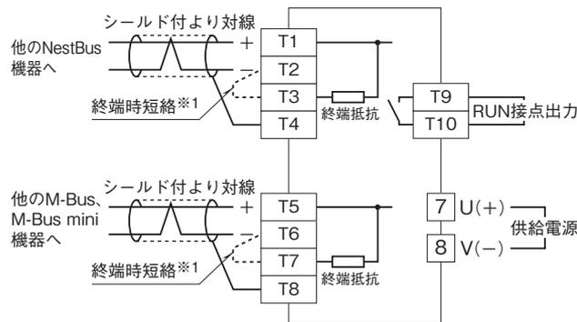
※1、より対線の伝送ラインが終端の場合は(=渡り配線がない場合)、端子T2、T3またはT6、T7間を付属のショートチップ(または配線)で短絡して下さい。
