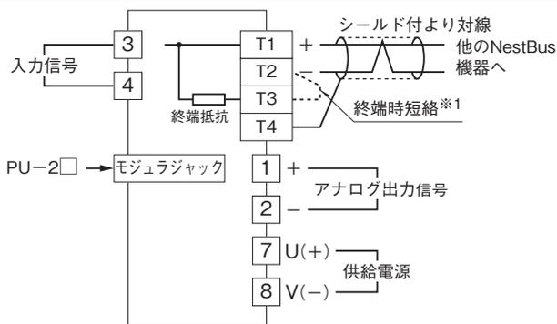
※1、より対線の伝送ラインが終端の場合は(=渡り配線がない場合)、端子T2、T3間を付属のショートチップ(または配線)で短絡して下さい。
