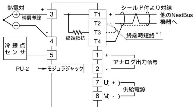
\*1、より対線の伝送ラインが終端の場合は (= 渡り配線がない場合)、端子 T2、T3間を付属のショートチップ (または配線) で短絡して下さい。ユニットが伝送ラインの途中に配線されているときは、端子 T2、T3間のショートチップをはずして下さい。
