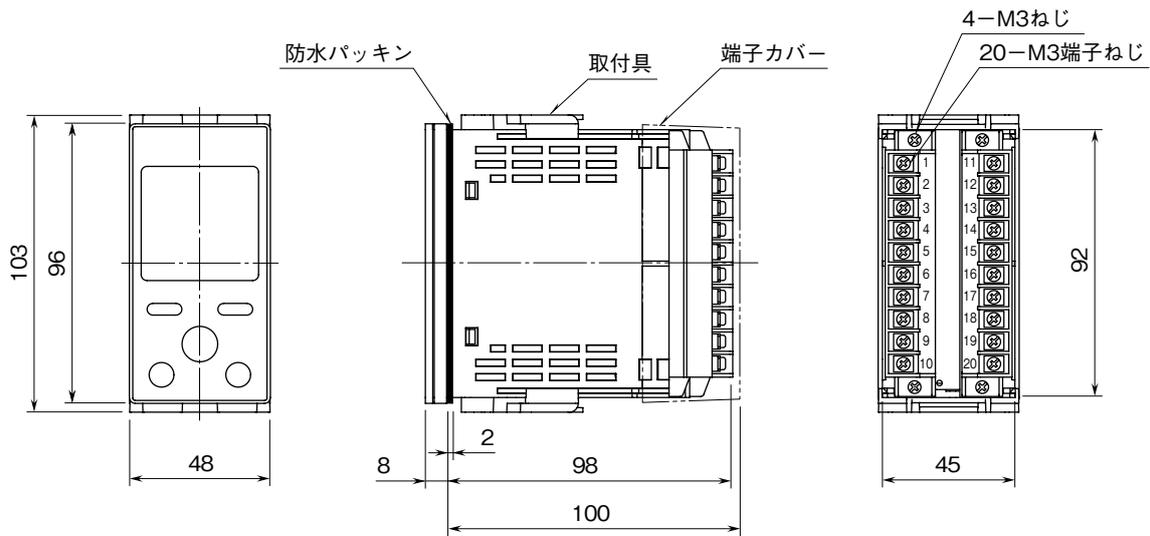
取付寸法図 (単位: mm)
