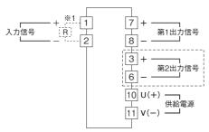
※1、電流入力時は入力抵抗器(R)が付きます。 注)破線部は2出力形のときのみ付きます。
