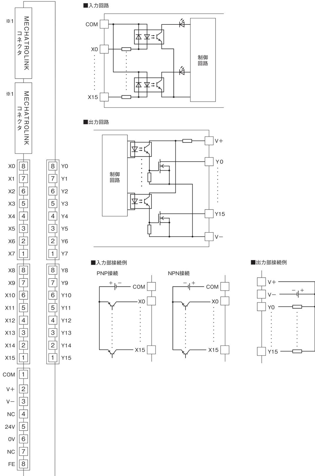
※1、MECHATROLINKコネクタは内部で接続されていますので、通信ケーブルはどちらにも接続できます。
