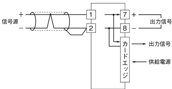
注) 本器は超高速形のため原理的に測定範囲内の周波数成分の入力信号に含まれるノイズだけを変換器内で減衰させることはできません。したがって'シールド付より対線'を使用するなど入力信号にノイズが混入しないように十分ご注意下さい。
