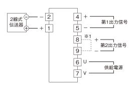
※1、第2出力をご利用されない場合は必ず短絡して下さい。 (注)スマートトランスミッタと組合わせる場合、負荷抵抗 は250Ωを使用して下さい。
