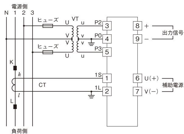
入力電圧回路の電圧が比較的安定しており、補助電源の仕様を満足する場合には、入力電圧回路から供給することも可能です。
