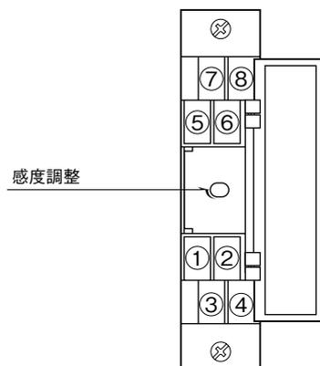
入力端子に最小使用入力電圧で最高使用周波数の信号を入力し、感度調整を左いっぱいに戻しておき、出力が現れるまで徐々に右に戻して下さい。なお、左いっぱいに戻しても出力がなくなるときや、入力信号が無電圧スイッチのときは、左いっぱいに戻して下さい。ノイズを避けるために感度を必要最小限に調整できます。
