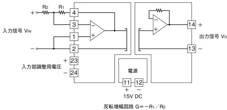
反転増幅する場合、 $V_O = -(R_1/R_2) \times V_{IN}$  となります。
