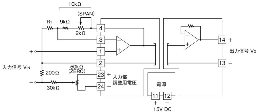
非反転増幅回路でゼロ、スパン調整を付ける場合、スパンアジャスタと  $9 \text{ k}\Omega$  の合成抵抗が  $10 \text{ k}\Omega$  として、ゲインは  $(1 + 10 \text{ k}\Omega / R_1) \times V_{IN}$  となります。
