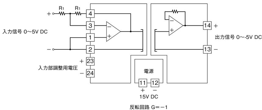
入力信号 0 V DC で出力 0 V DC、入力信号 + 5 V DC で出力 - 5 V DC と反転された信号が出力されます。
