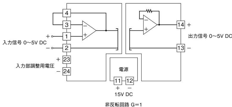
入力信号 0 ~ 5 V DC が出力信号 0 ~ 5 V DC として出力されます。
