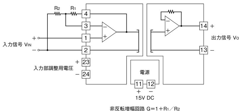
非反転増幅する場合、 $V_o = (1 + R_1 / R_2) \times V_{IN}$  となります。
