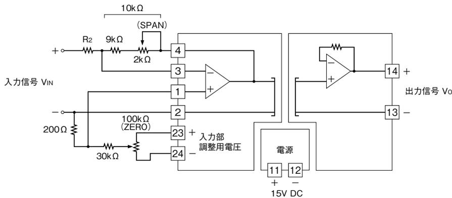
反転増幅回路でゼロ、スパン調整を付ける場合、スパンアジャスタと  $9 \text{ k}\Omega$  の合成抵抗が  $10 \text{ k}\Omega$  として、ゲインは  $-(10 \text{ k}\Omega / R_2) \times V_{IN}$  となります。
