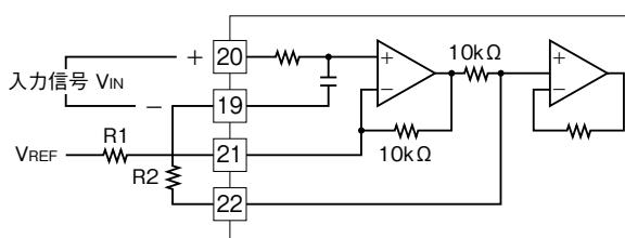
ゼロ、スパン調整は、下図のように外付け抵抗器とアジャスターで調整できます。
