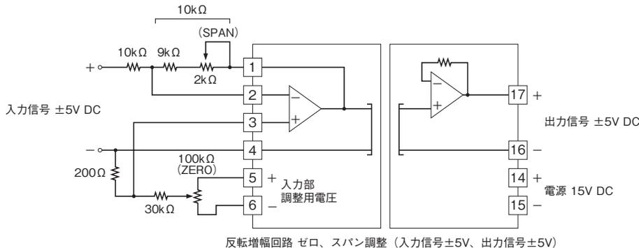
反転増幅回路でゼロ、スパン調整を付ける場合、スパンアジャスタと  $9 \text{ k}\Omega$  の合成抵抗が  $10 \text{ k}\Omega$  として、ゲインは  $-(10 \text{ k}\Omega / R_2) \times V_{IN}$  となります。
