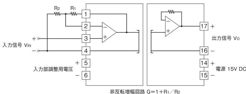
非反転増幅する場合、 $V_o = (1 + R_1 / R_2) \times V_{IN}$  となります。
