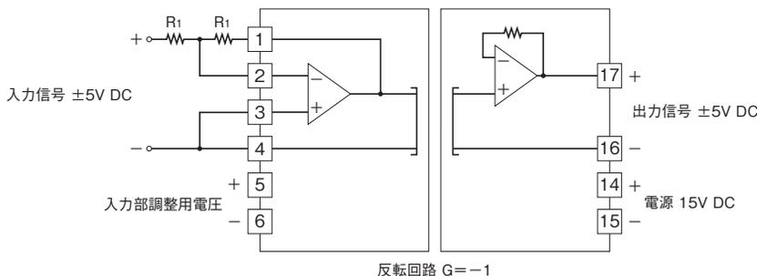
入力信号-5V DC で出力+5V DC、入力信号+5V DC で出力-5V DC と反転された信号が出力されます。ゲインは-1となります。
