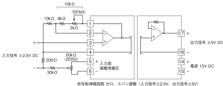
非反転増幅回路でゼロ、スパン調整を付ける場合、スパンアジャスタと  $9 \text{ k}\Omega$  の合成抵抗が  $10 \text{ k}\Omega$  として、ゲインは  $(1 + 10 \text{ k}\Omega / R_1) \times V_{IN}$  となります。
