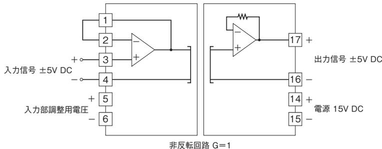
入力信号±5V DC が出力信号±5V DC として出力されます。ゲインは1となります。
