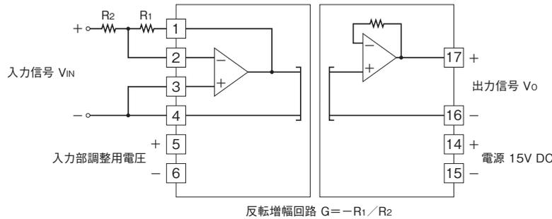
反転増幅する場合、 $V_O = -(R_1/R_2) \times V_{IN}$  となります。
