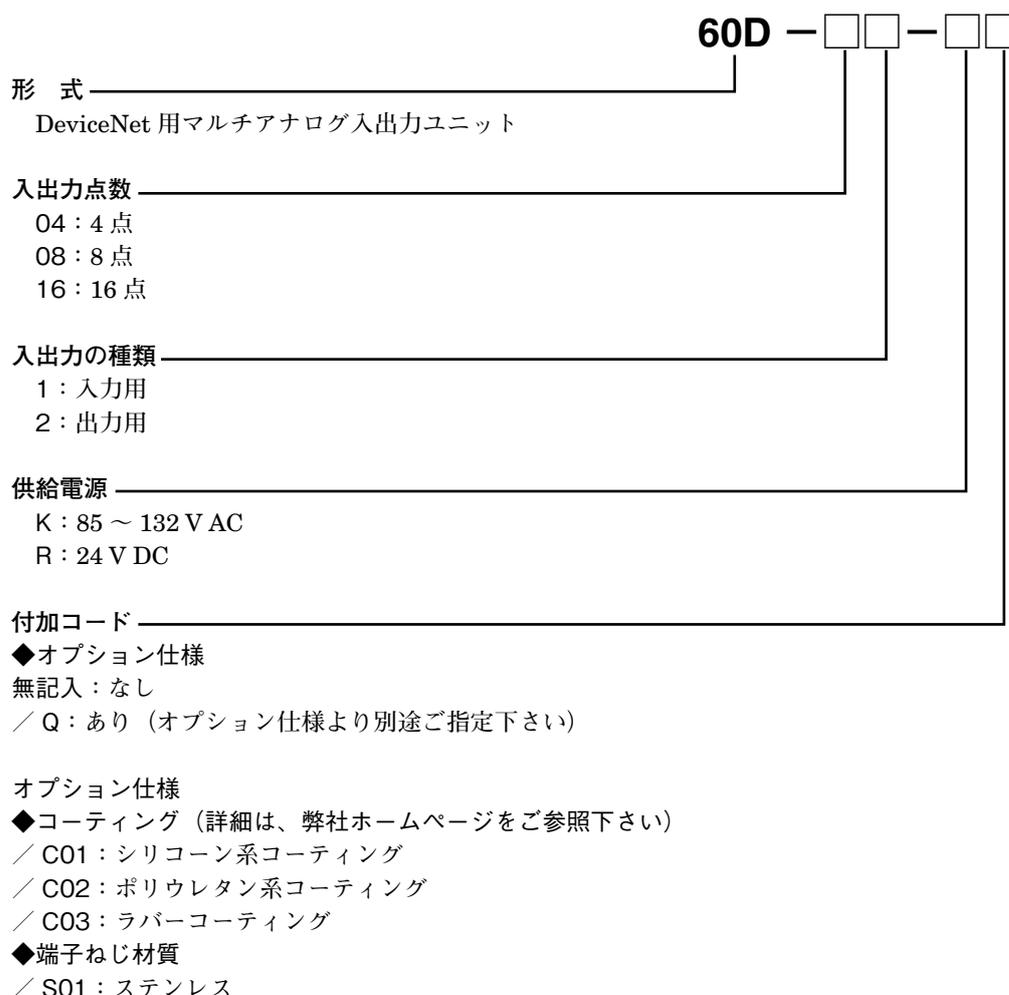
60D は、10・RACK シリーズ、18・RACK シリーズなどを用いることにより、多種多様な入力または出力を混在させて使用することができる DeviceNet 用マルチアナログ入出力ユニットです。
