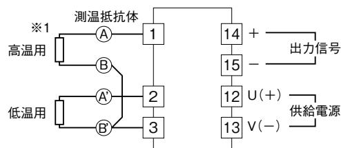
※1、測温抵抗体の接続は、必ず1番端子に高温用を接続して下さい。
