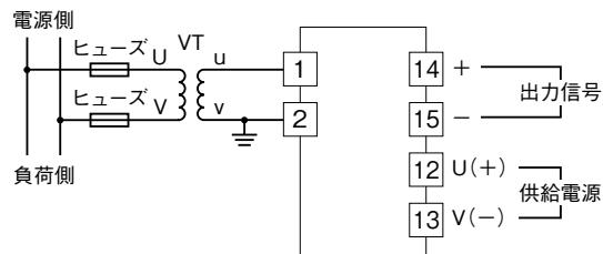
※、入力電圧回路の電圧が比較的安定しており、供給電源の仕様を満足する場合には、入力電圧回路から供給することも可能です。
