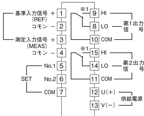
※1、出力形式コード“1”のときの電源OFF時の接点状態です。
