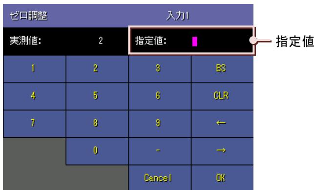
④<OK>ボタンをタッチすると、ゼロ調整したときの測定値が左側のウインドウに表示されます。
