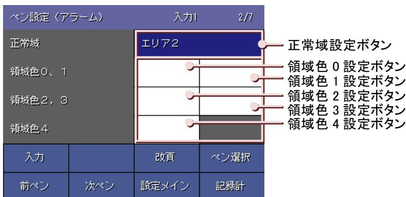
②画面下部に選択画面が表示されますので、いずれかをタッチして選択してください。
