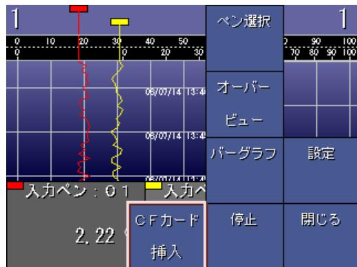
②挿入したCFカードに過去の収録データがある場合、「データファイルがリセットされます。よろしいですか？」と表示されます。そのまま、上書きしてもよい場合は<OK>ボタンをタッチしてください。<キャンセル>ボタンをタッチした場合は、内部メモリへのデータの書き込みを継続します。
