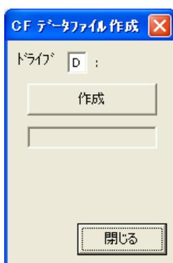
②CFカードが挿入されているドライブ名(例えば、Eドライブの場合は「E」)を入力し、<作成>ボタンをクリックします。CFカードへのファイルの作成が開始します。ファイルの作成状況がウインドウに表示されます。ファイル作成を中断する場合は、<キャンセル>ボタンをクリックして下さい。
