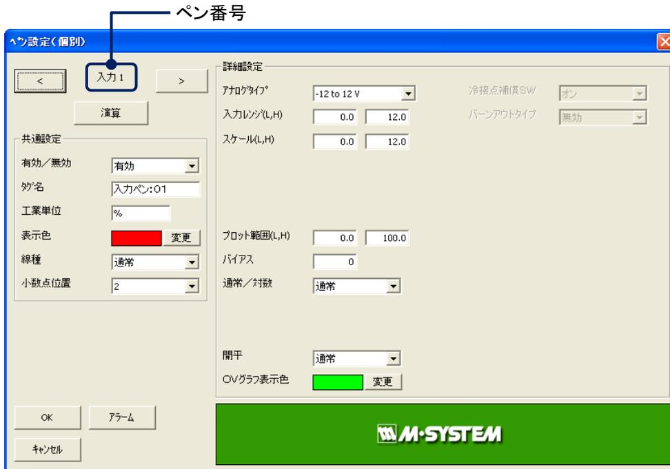
上図は 73VR2102 の設定画面で、ペン番号「入力 1～入力 2」はアナログ入力のチャンネル番号を示します。また、ペン番号「入力 3」は、トリガ入力端子の設定になります。トリガ入力端子への入力をデジタル入力(接点入力)として使用する場合に設定して下さい。
