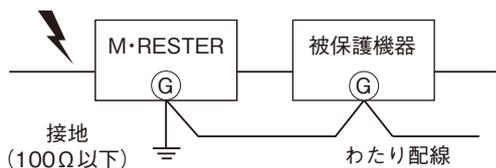
被保護機器のきょう体とM・RESTERの接地用端子を必ずわたり配線して下さい。被保護機器に接地端子がない場合は、M・RESTERのみ接地して下さい。DINレールアダプタ使用時は、取付ねじがM・RESTERの接地用端子になります。
