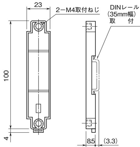
取付寸法図 (単位: mm)
