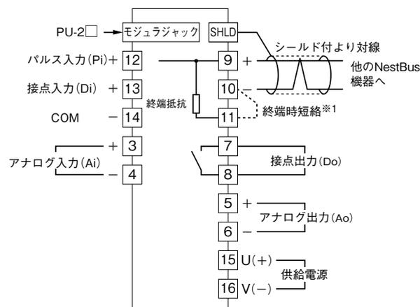
※1、より対線の伝送ラインが終端の場合は(=渡り配線がない場合)、端子10、11間を付属のショートチップ(または配線)で短絡して下さい。ユニットが伝送ラインの途中に配線されているときは、端子10、11間のショートチップをはずして下さい。
