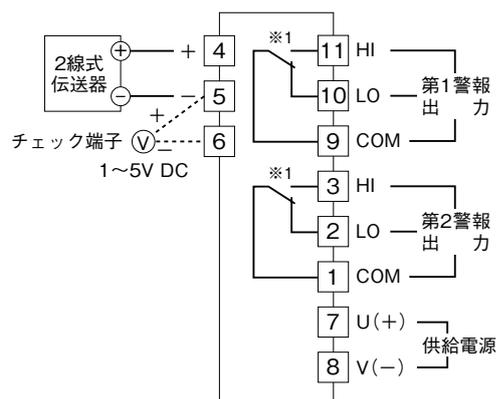
※1、警報出力コード“1、4”のときの電源OFF時の接点状態です。
