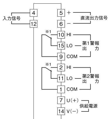
※1、警報出力形式コード“1、4”のときの電源OFF時の接点状態です。
