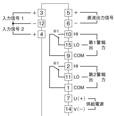
※1、警報出力形式コード“1、4”のときの電源OFF時の接点状態です。
