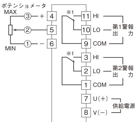
※1、警報出力コード“1、4”的ときの電源OFF時の接点状態です。
