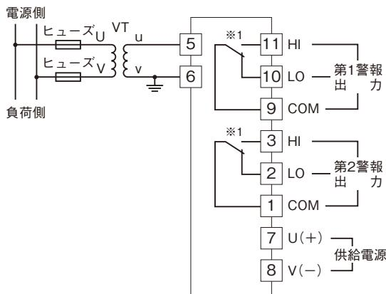
\*1、警報出力コード“1、4”的ときの電源OFF時の接点状態です。
