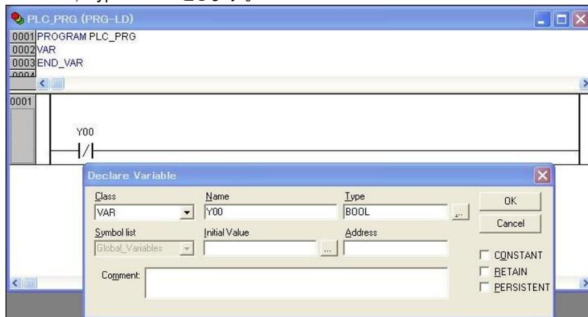
4)次にコイル出力を入力するためにツールバーから[Coil]をクリックします。変数名は上記で使用した”Y00”を指定します。その後新しい行を現在の行の後に追加するためメニューの[Insert]－[Network (after)]をクリックします。
