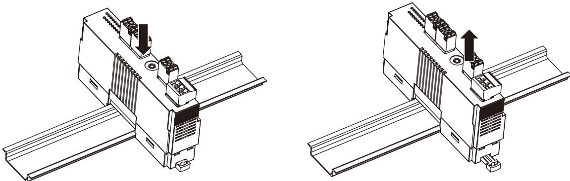
注）水平でなく垂直の DIN レールへ取付ける場合は、重力による滑り落ち防止のため、オムロン製エンドプレート（形式：PFP-M）、IDEC 製止め金具（形式：BNL6）などの固定金具のご使用をおすすめします。
