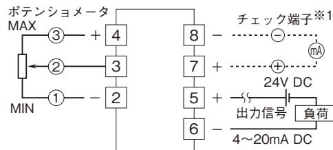
※1、内部抵抗10Ω以下の直流電流計を接続して動作チェックすることができます。
