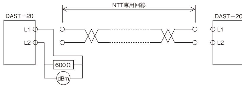
② NTT 専用回線に一方のみ DAST-20 を接続します。電源を“ON”にすると DAST-20 はキャリア信号を出力しますので、この送出レベルを他方に 600 Ω を接続し測定します。
