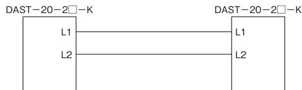
搬送電信端局装置で中継していない場合、接続は上図のようになります。回線の接続は“L1”と“L2”との接続が逆になっていることがありますが、どちらに接続しても正常に動作します。
