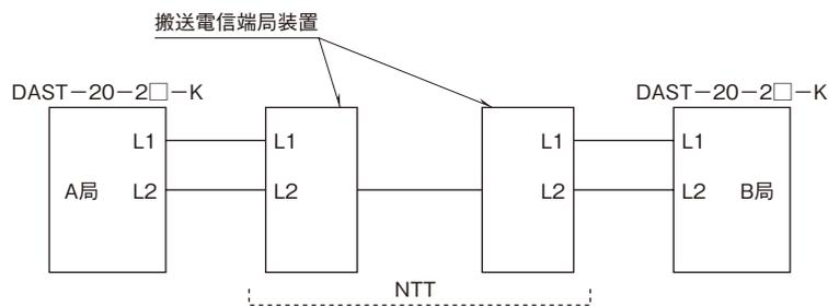
搬送電信端局装置で中継している場合、接続は上図のようになります。回線の接続は A 局側や B 局側で配線が逆になっても通信には影響ありません。
