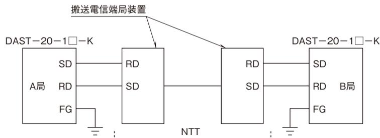
搬送電信端局装置で中継している場合、接続は上図のようになります。回線の接続は A 局側で配線が逆の場合と B 局側で配線が逆の場合がありますので 2 カ所での配線チェックが必要です。配線が逆の場合にはそれぞれ“RD”と“SD”を逆にします。
