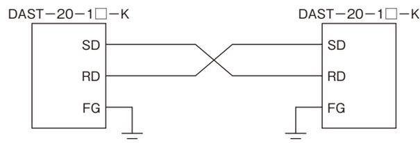
搬送電信端局装置で中継していない場合、接続は上図のようになります。回線の接続は“SD”と“RD”との接続が逆になっていることがありますので、どちらかのユニットの接続を逆により正常になります。
