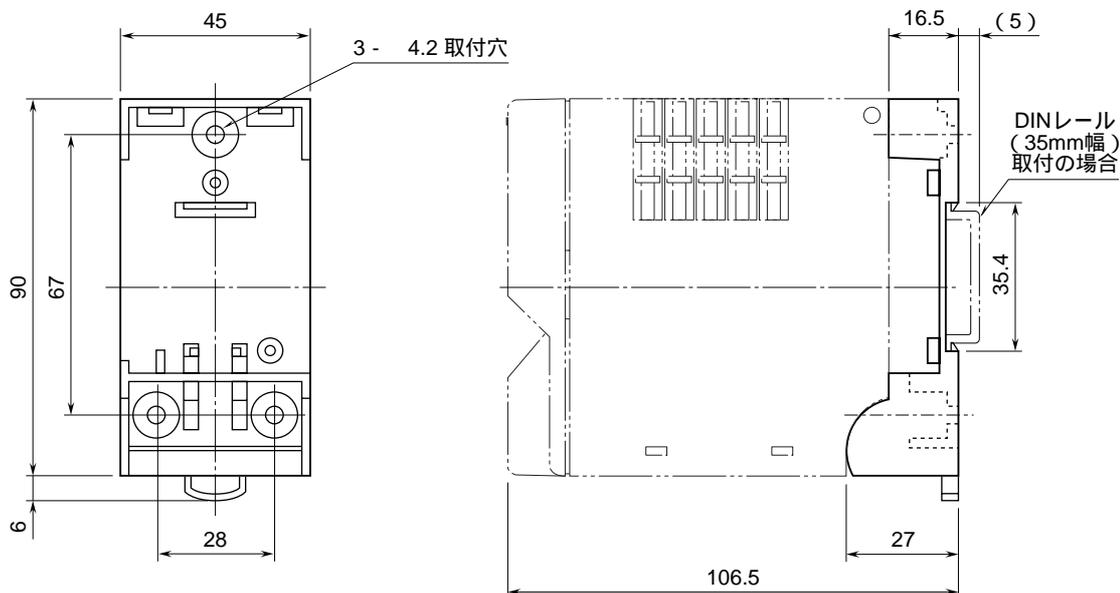
注：DINレール取付を行う場合は、オムロン製 エンドプレート（形式：PFP - M）、和泉電気製 止め金具（形式：BNL6）などの固定金具のご使用をお奨めします。
