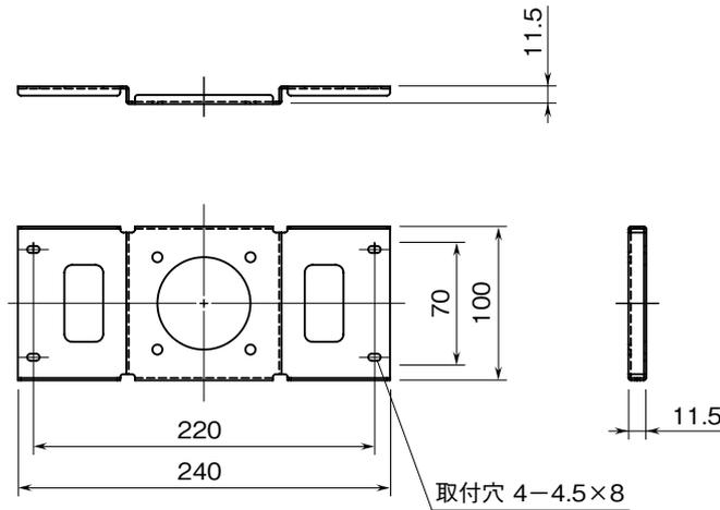
取付寸法図(単位: mm)
