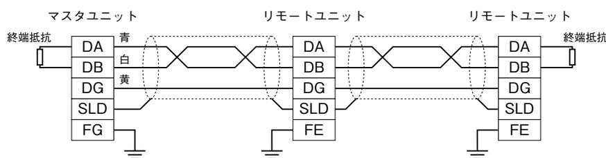
両端のユニットには、“DA”-“DB”間に“終端抵抗”を接続して下さい。
