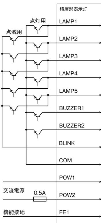
注1、ランプの点灯入力(点灯用)と点滅入力(点滅用)を同時にONした場合、故障しますので絶対に行わないで下さい。
