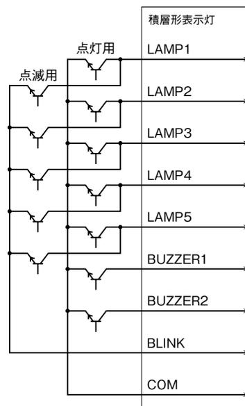
注1) ランプの点灯入力(点灯用)と点滅入力(点滅用)を同時にONした場合、点灯入力が優先されます。またこのとき点滅入力をONしている別のランプがあると、そのランプも点灯動作になります。
