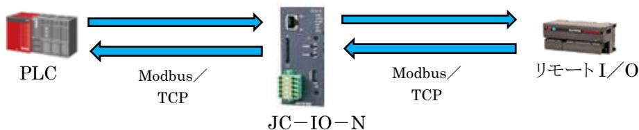
図 31 使用例 (PLC の I/O 拡張)
