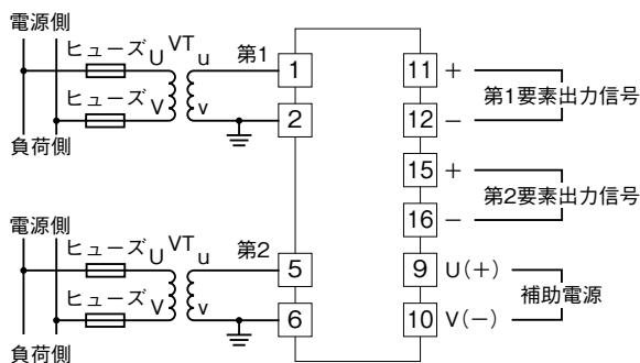
入力電圧回路の電圧が比較的安定しており、補助電源の仕様を満足する場合には、入力電圧回路から供給することも可能です。
