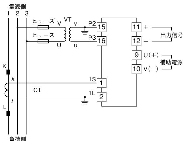
入力電圧回路の電圧が比較的安定しており、補助電源の仕様を満足する場合には、入力電圧回路から供給することも可能です。
