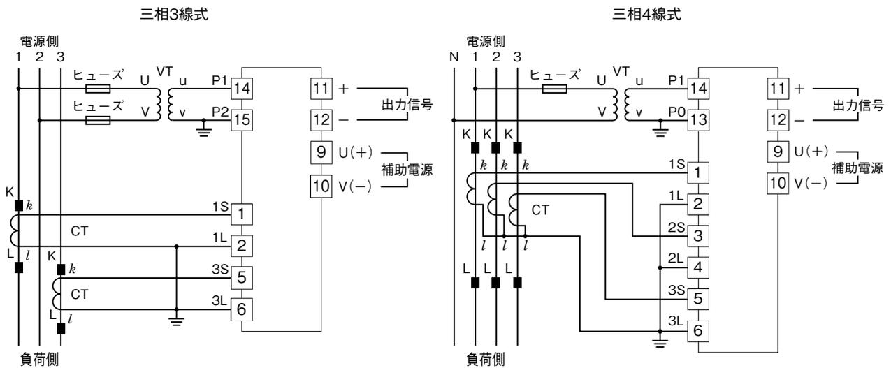
入力電圧回路の電圧が比較的安定しており、補助電源の仕様を満足する場合には、入力電圧回路から供給することも可能です。
