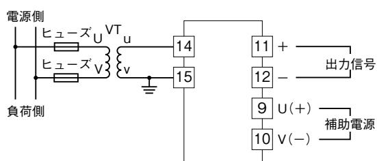
入力電圧回路の電圧が比較的安定しており、補助電源の仕様を満足する場合には、入力電圧回路から供給することも可能です。
