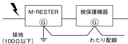
被保護機器のきょう体とM-RESTERの接地用端子を必ずわたり配線して下さい。被保護機器に接地端子がない場合は、M-RESTERのみ接地して下さい。
