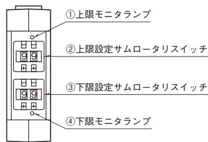
各モニターランプはそれぞれ上限、下限警報用リレーが励磁状態のとき点灯します。
