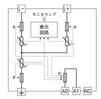
heta : 感熱切離し回路 注) 警報出力端子(AO、A1)は、警報出力コードAのときのみ付きます。
