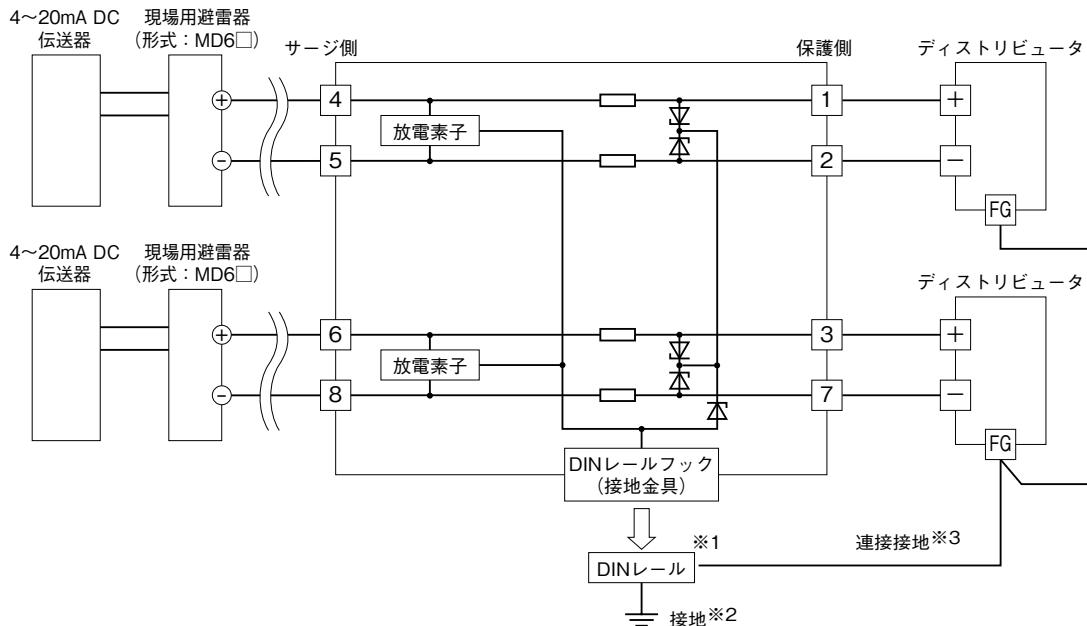
※1、アルミニウム製DINレールは、酸化皮膜によって本器と接地の導通性を阻害する恐れがあります。鉄や銅製のレールをご使用下さい。
