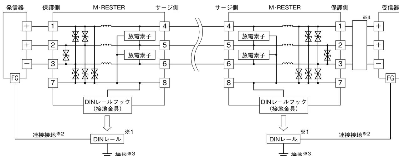
※1、アルミニウム製DINレールは、酸化皮膜によって本器と接地の導通性を阻害する恐れがあります。鉄や銅製のレールをご使用下さい。
