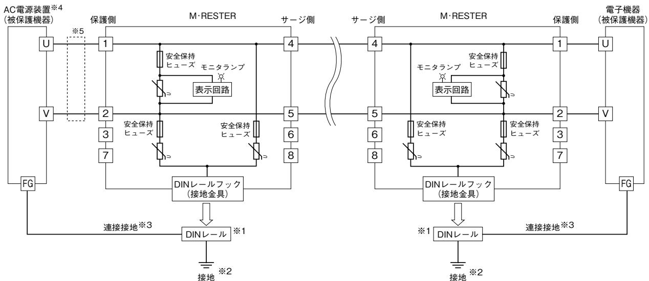
※1、アルミニウム製DINレールは、酸化皮膜によって本器と接地の導通性を阻害する恐れがあります。鉄や銅製のレールをご使用下さい。
