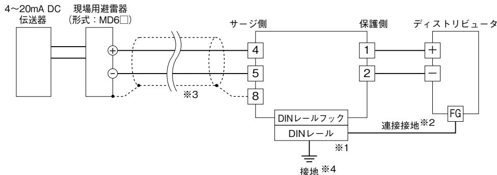
※1、アルミニウム製DINレールは、酸化皮膜によって本器と接地の導通性を阻害する恐れがあります。鉄や銅製のレールをご使用下さい。
