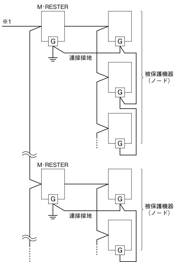
※1、IEC 61158-2に準拠したフィールドバス機器は、9~32V DCの間で動作できることを要求しています。
