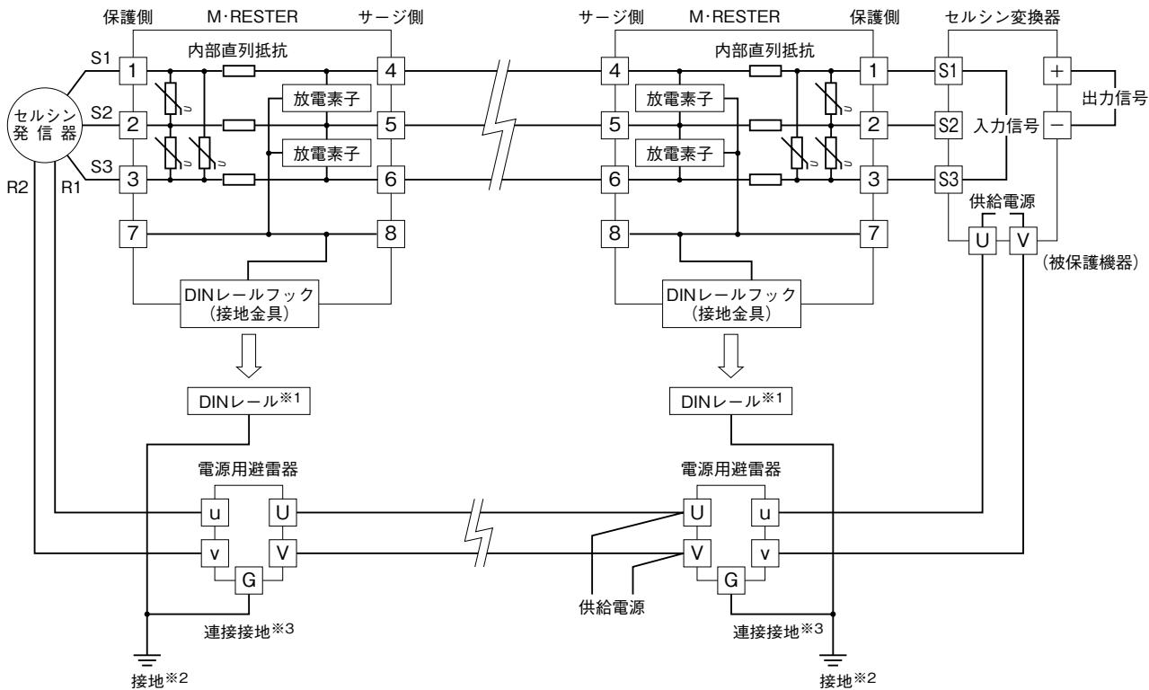
※1、アルミニウム製DINレールは、酸化皮膜によって本器と接地の導通性を阻害する恐れがあります。鉄や銅製のレールをご使用下さい。
